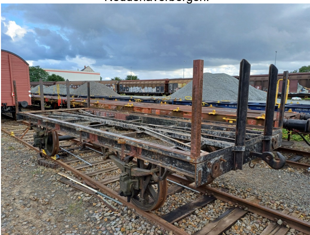
Die Schleifarbeiten am Flachwagen G 102 sind vorerst abgeschlossen.
