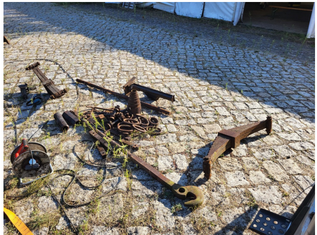
Geborgen wurden Federn, Schaken, Zughaken und andere wichtige Ersatzteile.
