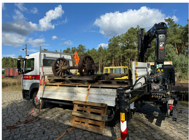
Bergung der Radsätze und Stangenpuffer eines Ersatzteil-Spendergüterwagens aus Südbrandenburg.
